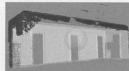
Abb. 2: Darstellung des Obergeschosses im Pompejanum als dichte Punktwolke
